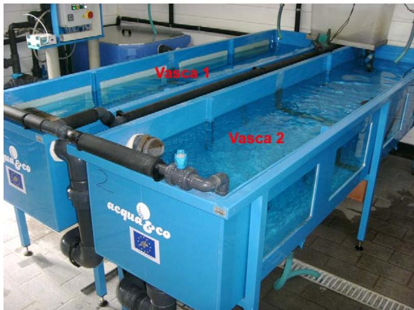
FIGURA 2.4.1-1. VASCHE DELL'IMPIANTO DI RICIRCOLO UTILIZZATE PER L'ALLEVAMENTO DELLO SCAZZONE
