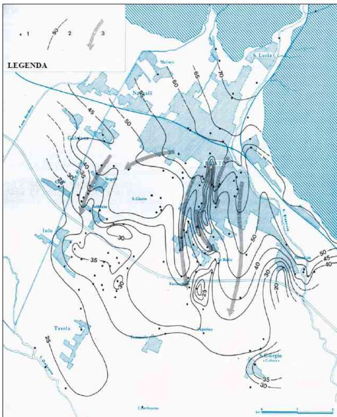
FIGURA 17 - MORFOLOGIA DEL TETTO DELLE GHIAIE ACQUIFERE. LEGENDA: 1) POZZI CON CONTROLLO LITOSTRATIGRAFICO. 2) CURVE DI UGUALE QUOTA (IN M SLM). 3) PERCORSI PROBABILI DEL FIUME BISENZIO. (LANDINI ET ALTRI., 1990)
